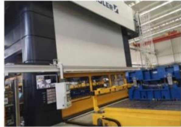
五菱汽车公司 (多工位冲压线)
