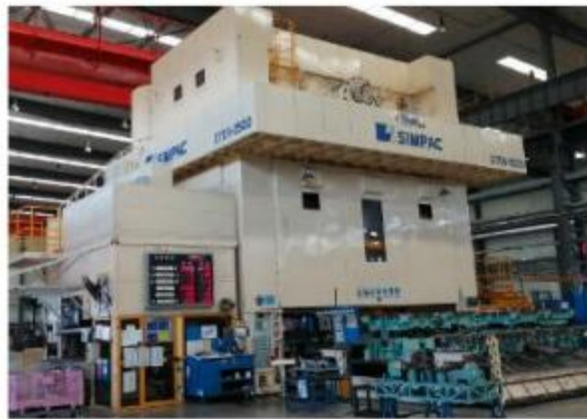
东风模冲公司 (多工位冲压线)
